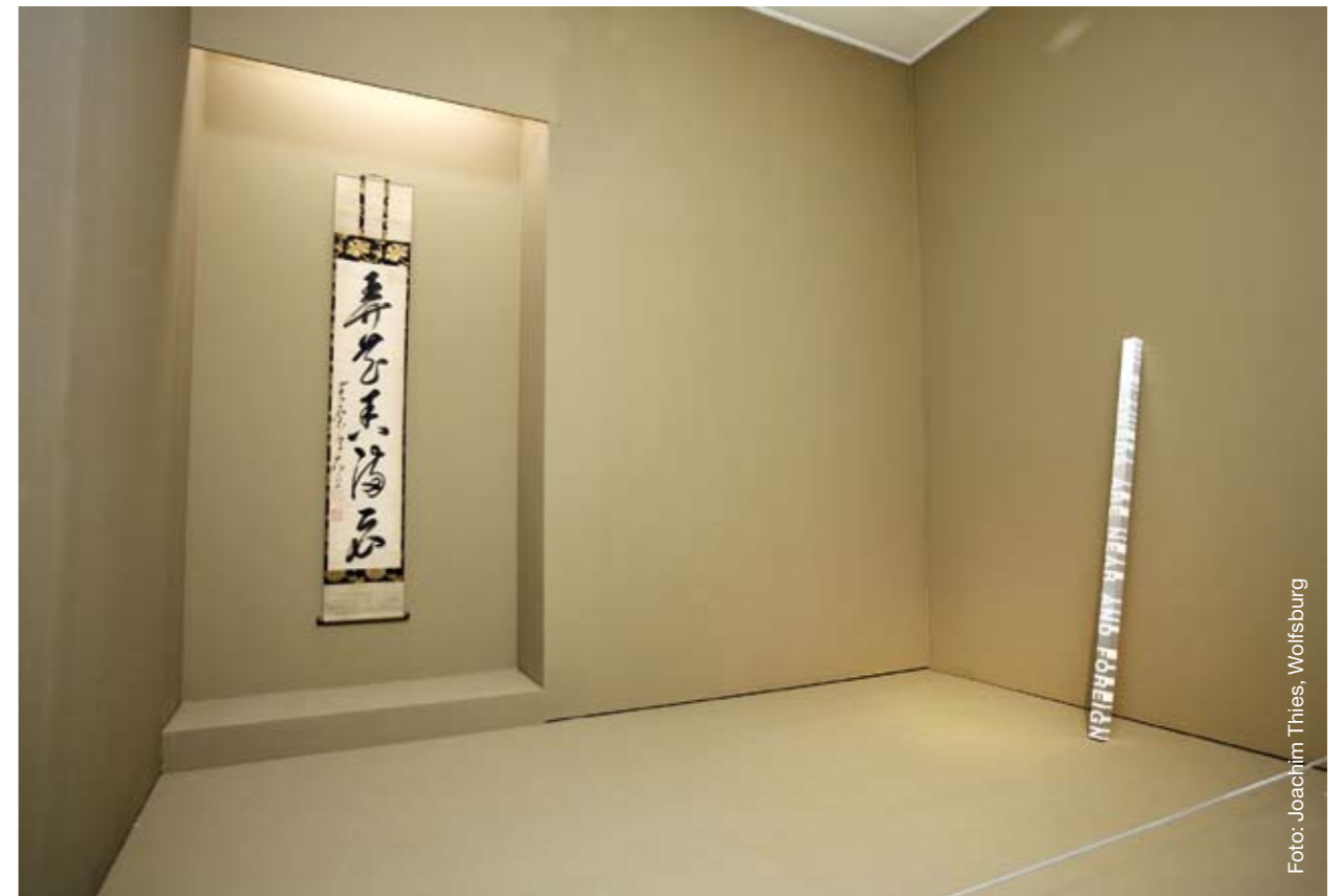
Integration einer 3 m hohen Wandnische mit indirekter Beleuchtung im oberen Teil der Stellwand
